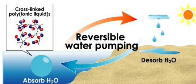
図 14 温度変化に応じて水を吸脱着するイオン液体
