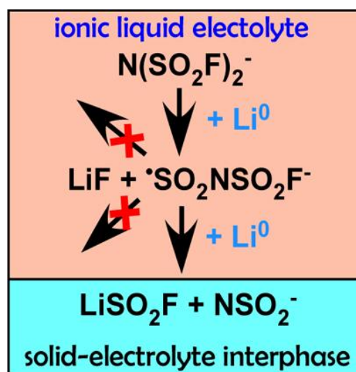
図 4 FSA - アニオンの還元分解機構の概略図。 アメリカ化学会より許可を得て転載。 13
