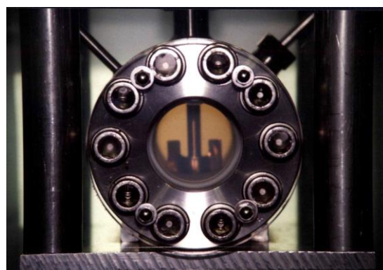
図1 西川研に入り初めて行った「夕焼け現象」の実験で当時撮影した写真（中央の黄色部分が超臨界流体）
