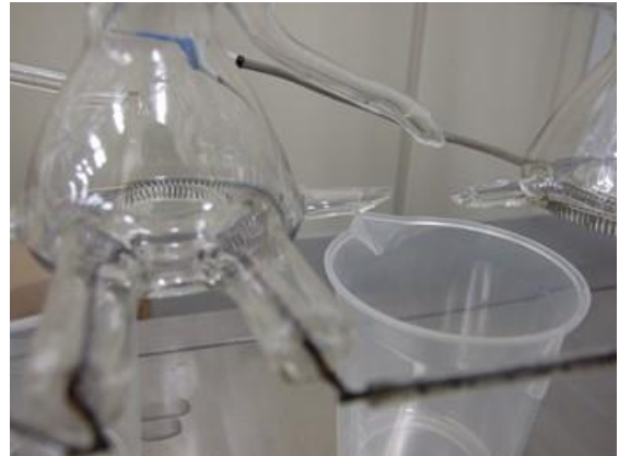
図2 筆者が破壊した高真空ラインのヒックマンポンプ(2008年8月)
