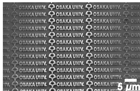
Fig. 8 Si ウェハ上の [AllyEtIm][Tf 2 N] に EB をラスタースキャンすることで作製した高分子パターン。
